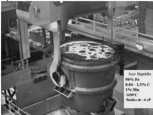
Figura 79: Aço líquido produzido no conversor sendo transportado para o lingotamento ou para as instalações de metalurgia de panela.
