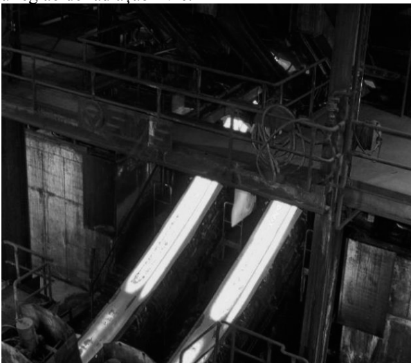
Figura 84: Lingotamento contínuo em dois veios.
