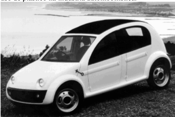
Figura 7: Automóvel experimental projetado pela Chrysler® com carroceria produzida em uma única peça de plástico, o que pode resultar em redução de até 25% de seu preço final.
