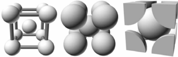
Figura 14: Representação esquemática de uma célula unitária da estrutura Cúbica de Corpo Centrado (CCC).
